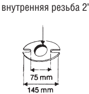
овальные контрфланцы 2" DN 40, PN6/PN 10 с прокладками и болтами для перехода с резьбового патрубка 2" на фланец DN 40
