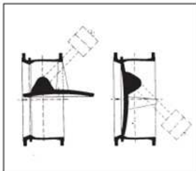
Работа обратного клапана с наклонным седлом ERHARD
